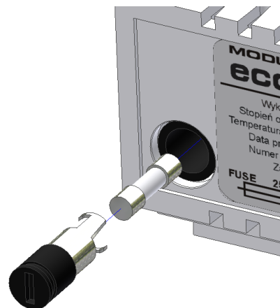
Rys. 7.1 Wymiana bezpiecznika w module ecoLAMBDA
