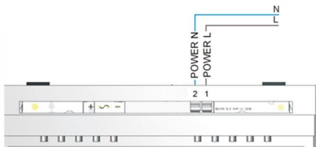
Rys. 6.9 Podłączenie zasilania sieciowego do ecoLAMBDA 2B
