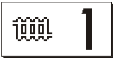
Rys. 13.4 Sygnalizacja pracy wyjść w trybie ręcznym
