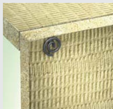
FOT. 514.4. Wygięta, ostra końcówka wkrętu CONLIT SØM (wewnątrz płyty) obraca się pod kątem prostym w płycie bocznej. W ten sposób uzyskuje się trwałe i zwarte połączenie narożnikowe. Kontrola powykonawcza: wkręt do mocowania CONLIT SØM jest prawidłowo obrócony, jeśli wygięta końcówka wkrętu jest umiejscowiona możliwie najdalej od krawędzi płyty.
