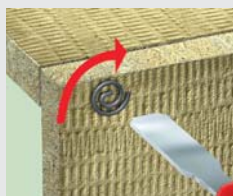
FOT. 514.3. Następnie wkręt zostaje trwale osadzony w szczelinie i przekręcony 1/4 obrotu w prawo.
